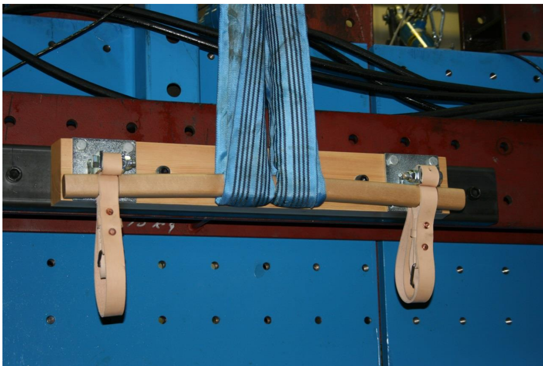
Bild 6. Provning av handtag med belastning 500 kg i 5 minuter
