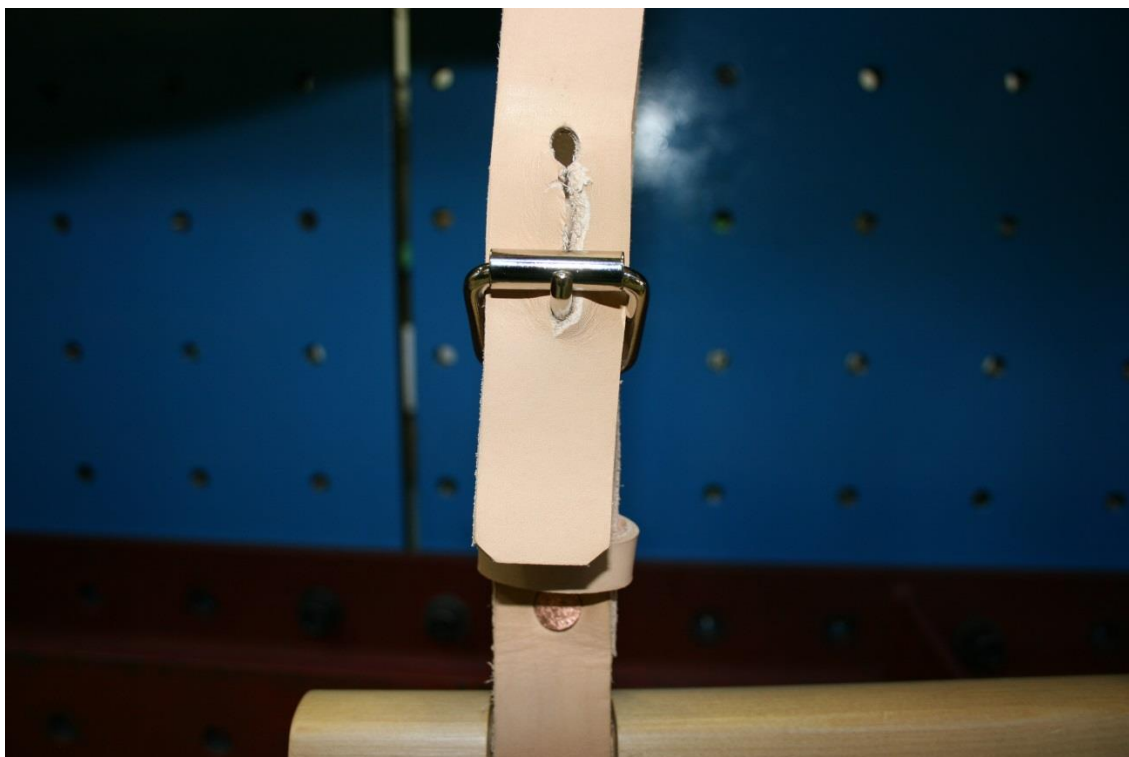
Bild 7. Brott i rem vid dragprov av redskapet
