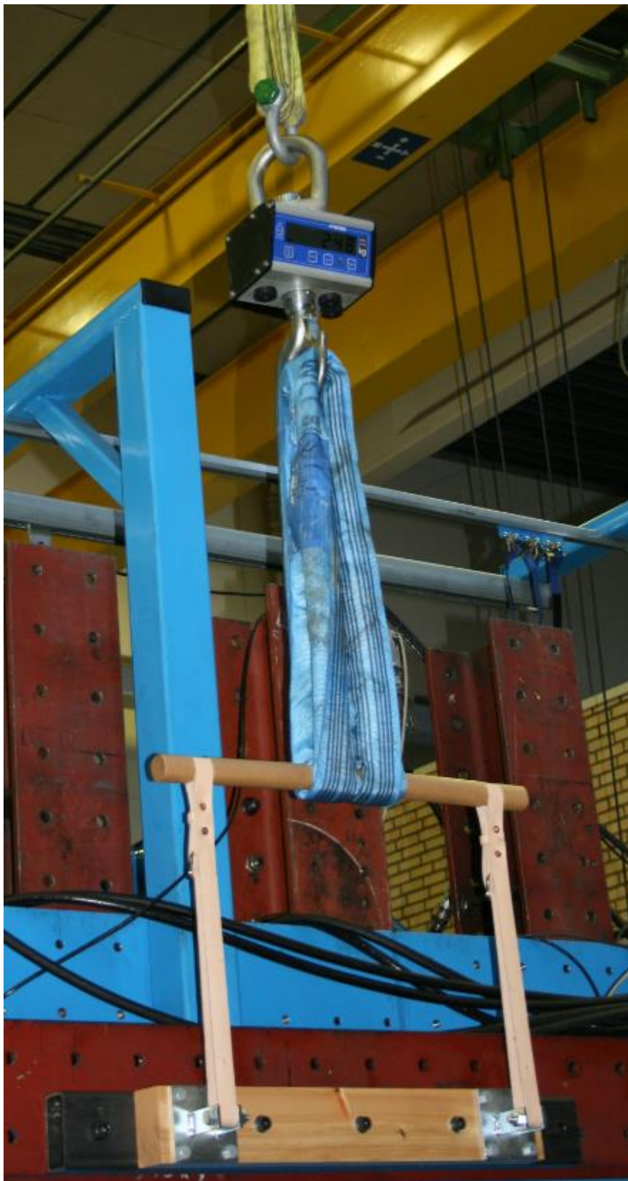
Bild 5. Dragprovning med 300 kg i 5 minuter
